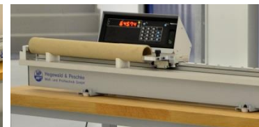
Längenmessung an Papprohren
